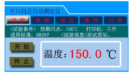
点击"开始",升降杆落下,开始测试;点击"终止",停止试验,升降杆升起。"试验条件"处显示测试的设定条件,包括预期闪点、打印机开关设置、试验所适用的标准等。"试验信息"处显示试验的进程信息。
