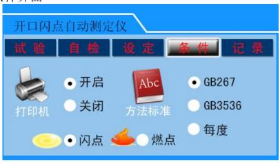
该界面用以设置打印机的开启、关闭及测试试样所符合的标准、试样测试类型(闪点或燃点,本机型只对闪点进行测试,如需要燃点测试请与厂家联系),采用的标准包括 GB267-88 和 GB3536-2008,设定为"每度"时,测试试样开始后,在温度上升约 5℃时,每升高 1 度即点火测试一次,试验试样是否闪火,适用于预期闪电或燃点较低的试样。
