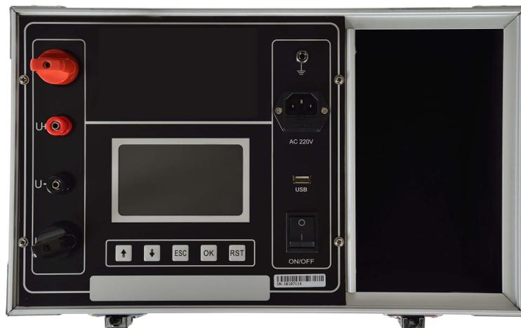
图一 回路电阻测试仪面板
