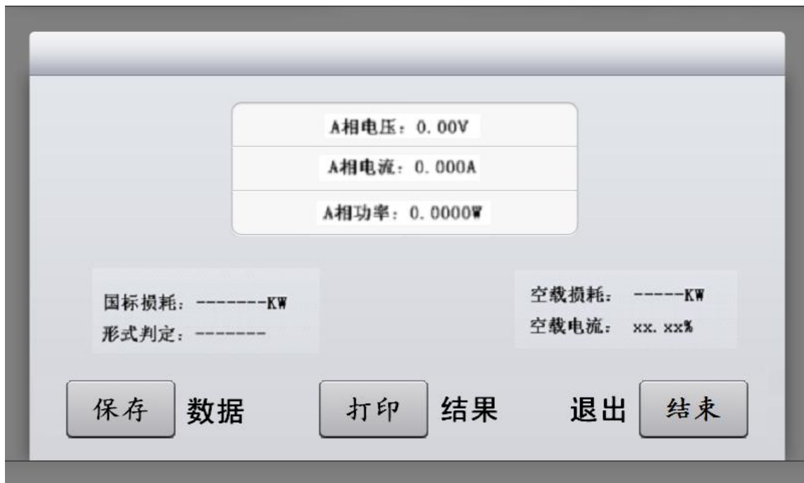
图八 单相空载测试
