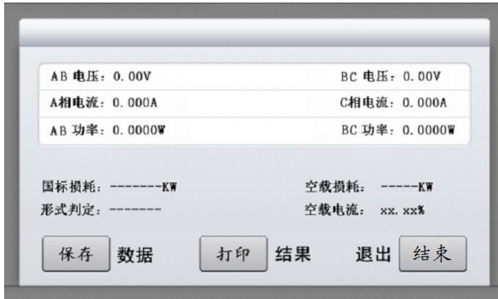
图七 两元件法空载测试
