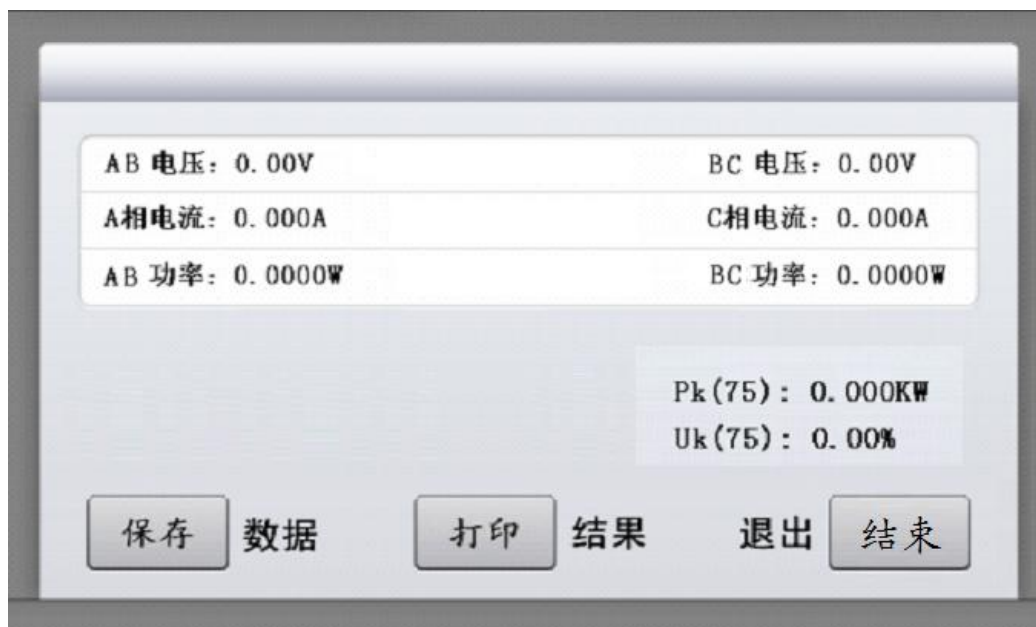
图十一 两元件法负载测试
