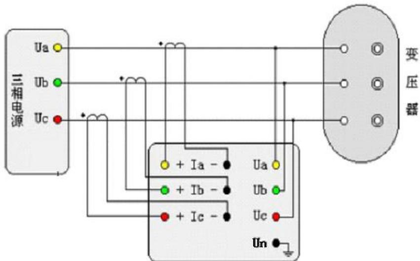
图三十三 三相空载损耗测试的 CT 接线示意图
