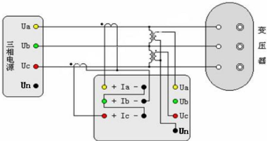
图二十九 两元件法空载损耗测试的 PT 和 CT 接线示意图
