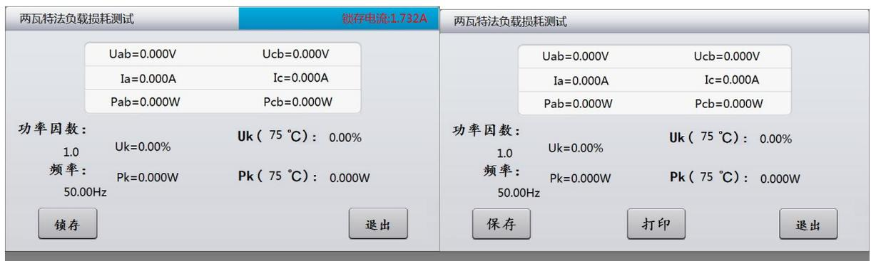
图十四-1 两瓦特法负载损耗测试
