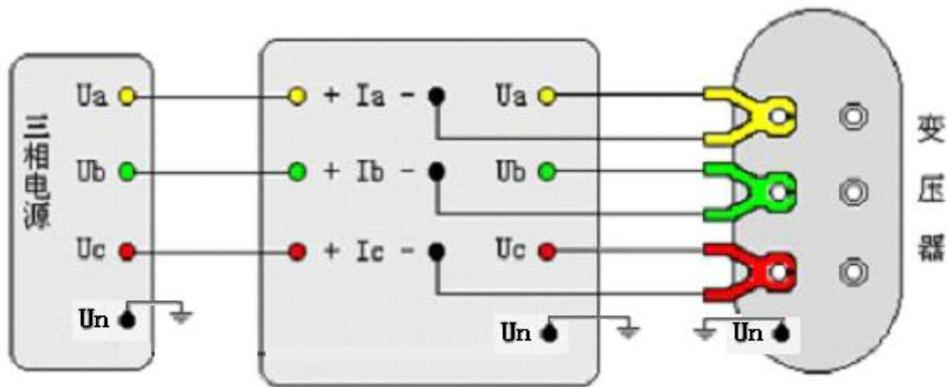
图三十一 三相空载损耗测试的直接接线示意图
