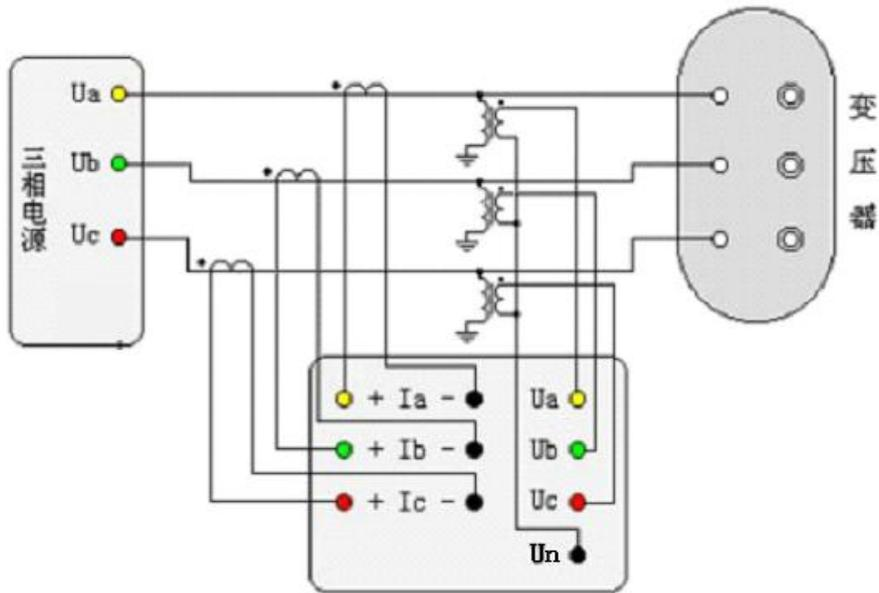
图三十二 三相空载损耗测试的 PT 和 CT 接线示意图
