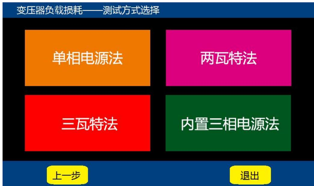
图十二 负载测试方式选择界面
