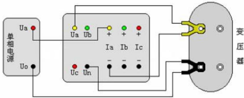
图十九 单相空载测试直接接入法示意图
