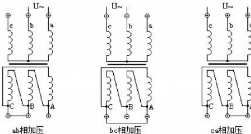
图二十四 加压绕组为无中性点Y型连接的接线示意图
