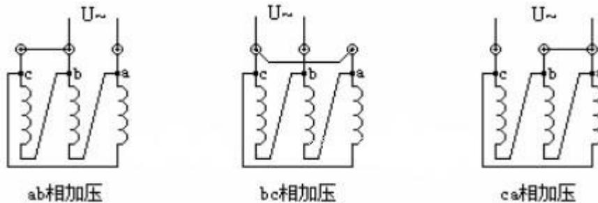
图二十二 加压绕组为 $\Delta$ 型连接的接线示意图
