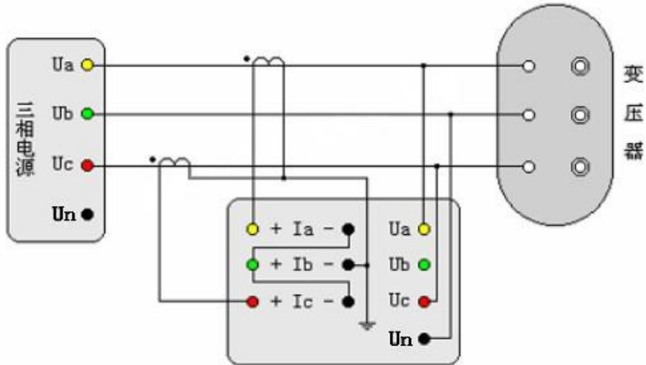
图三十 两元件法空载损耗测试的 CT 接线示意图
