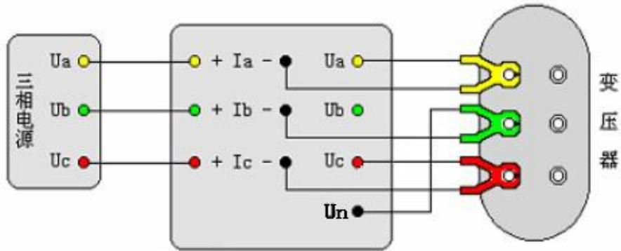
图二十八 两元件法空载损耗测试的直接接线示意图
