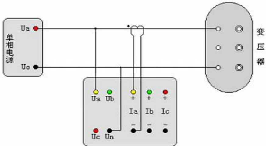
图二十七 单相电源测量三相变压器空载损耗外接 CT 的接入法示意图
