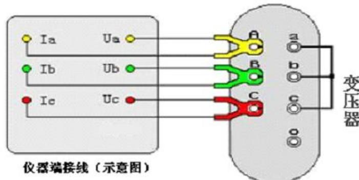
图十八 容量测试及有源负载测试的接线方法
