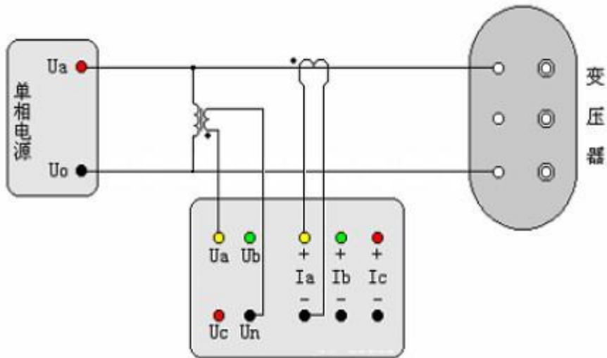
图二十六 单相电源测量三相变压器空载损耗外接 PT 和 CT 的接入法示意图
