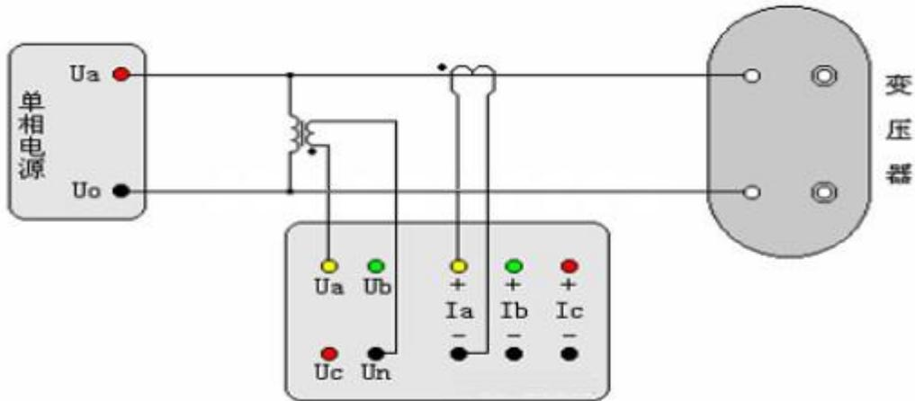
图二十 单相空载测试外接 PT 和 CT 的接线示意图
