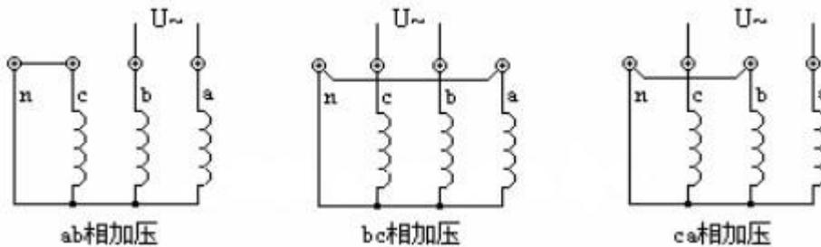
图二十三 加压绕组为有中性点Y型连接的接线示意图
