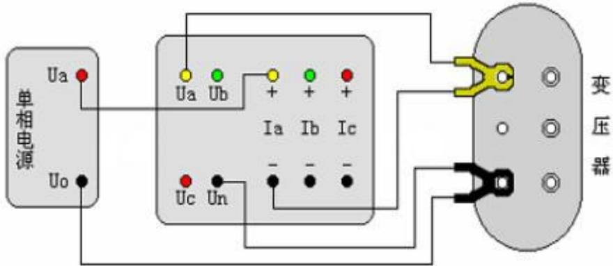
图二十五 单相电源测量三相变压器空载损耗的直接接入法示意图
