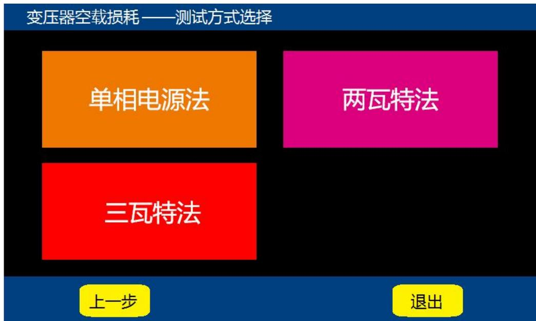
图七 空载测试方式选择界面
