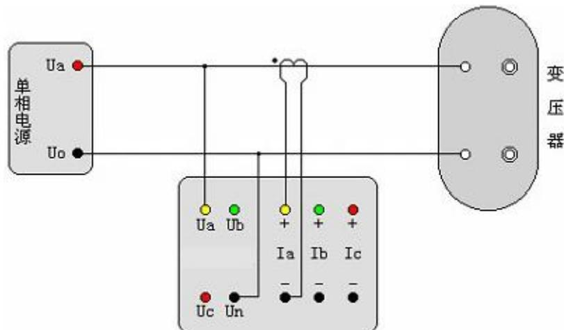
图二十一 单相空载测试外接 CT 的接线示意图
